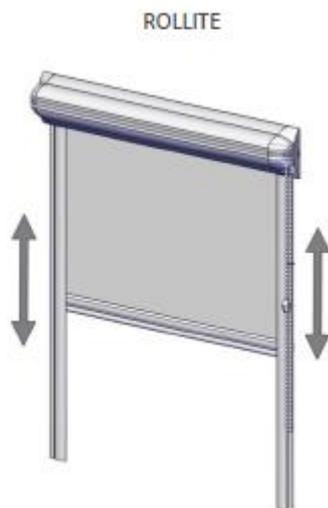
Das Hochziehen oder Herunterlassen des Rollos erfolgt mittels einer Kette. Ziehen Sie stets an einem Kettenstrang, und zwar in Richtung nach unten. Das Ziehen an beiden Strängen der Kette kann ihre Beschädigung zur Folge haben.
